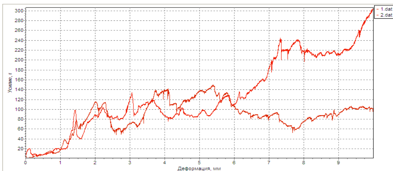
Рис. 1 Изменение усилия нагружения на индекторе «Игла» в зависимости от глубины её внедрения в экструзионный продукт
